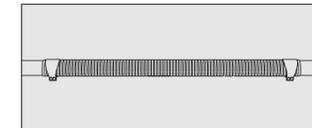
5 Pasang kan Hose Clamp Sterilis / Klem Selang untuk mengaitkan selang flexible pada pipa paralon Lumuri pipa paralon dan sock drat dengan lem.
